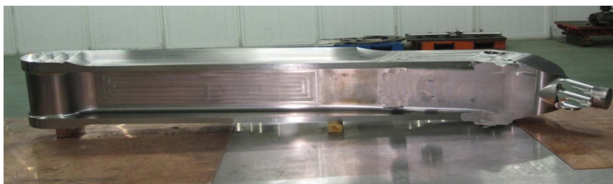
电子束熔丝沉积钛合金结构件
