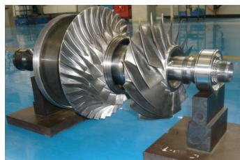
激光直接沉积用于整体叶轮的损伤修复
